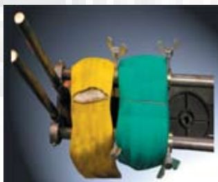
Comparaison entre élingue ronde Duplix et élingue ronde Duplix Inox après 300 intervalles
