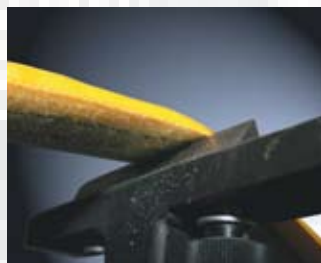
test abrasion de l'élingue ronde Duplix
